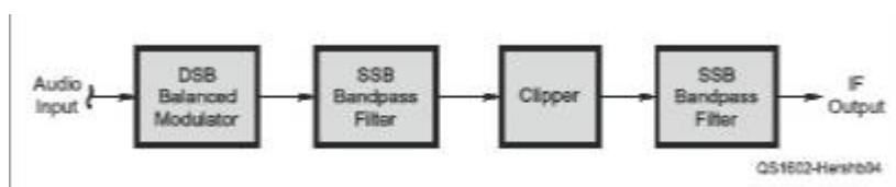
Рис. 4. Стандартный ограничитель сигнала по РЧ
